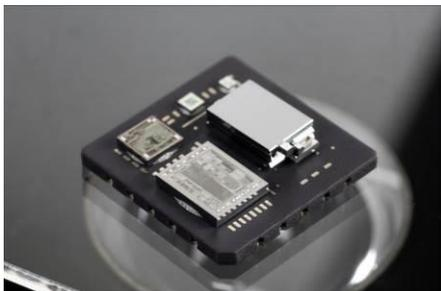
Colibrys 的加速度传感器是基于硅 MEMS 的电容式传感器。MEMS 制造过程中提供了一个替代传统的宏观机械加工和装配的技术。这项技术源于微电子工业，把传统的集成电路（IC）工艺和特定的 MEMS 加工工艺的技术相结合，研制生产出微观机械结构的产品。
